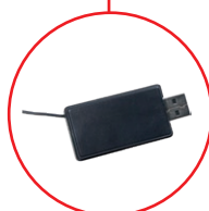
USB sans fil pour récupération des données sur PC, à positionner à moins de 8 m des compteurs de passage.
